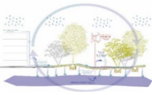
Métabolisme de rafraîchissement urbain, associant, eau de pluie, de nappe, sol et végétalisation - Bruxelles
